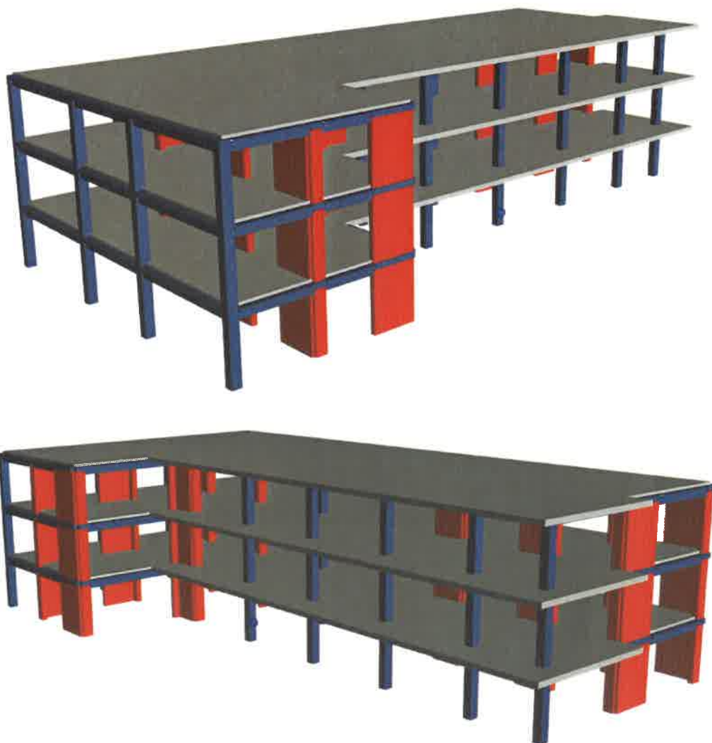
Fig. 8.1: Vedere 3D structura de rezistenta clădire (model structural spațial realizat in cadrul programului de calcul ETABS cu elemente finite)
